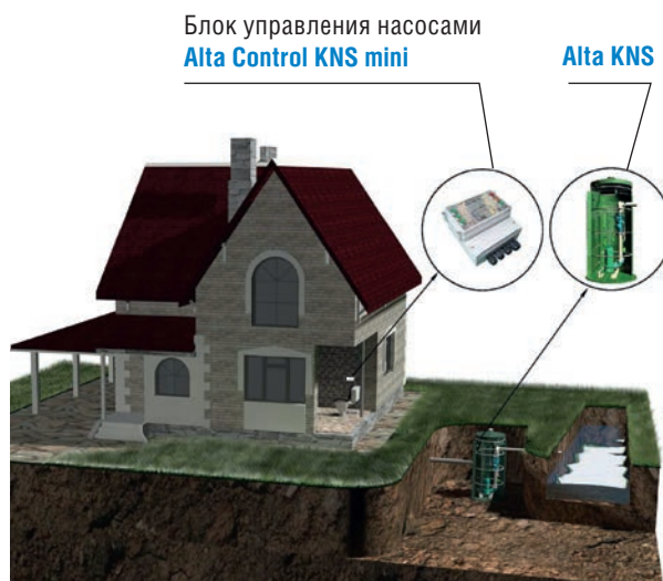
Пример размещения блока управления насосами
